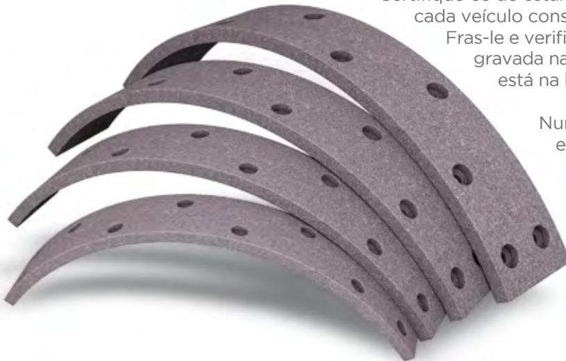
Certifique-se de estar usando a lona correta para cada veículo consultando o Catálogo de Aplicação Fras-le e verificando a identificação da referência gravada na lona. Essa gravação normalmente está na lateral da lona.
