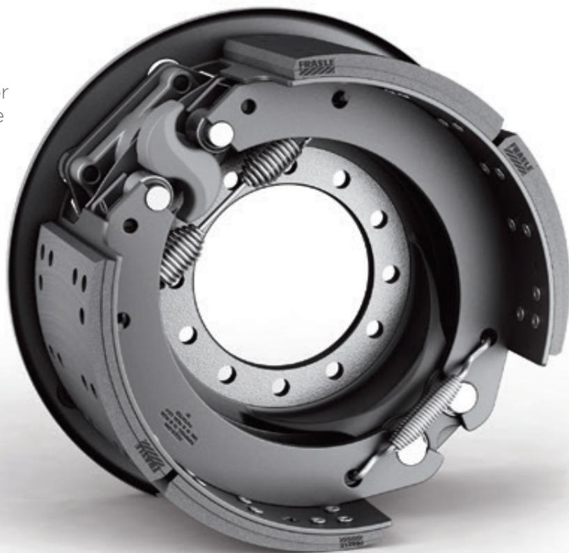
Já no sistema pneumático os componentes são: câmara de freio, ajustador, eixo S, patins, lonas de freio e tambor. O funcionamento ocorre da seguinte forma: a câmara é pressurizada pelo ar comprimido e sua haste movimenta o ajustador, que gira o eixo S, que por sua vez forçam os patins contra o tambor, gerando a força de frenagem.
