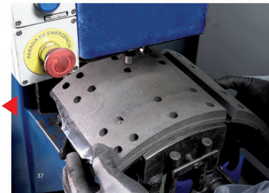
Quando acionar o pedal da rebidadeira, mantenha-o pressionado por 3 segundos. Esse é o tempo suficiente para que o remanche seja completamente realizado. Não se deve ter pressa nessa etapa. Esta operação é para evitar trincas e folgas entre as lonas de freio e a sapata.
