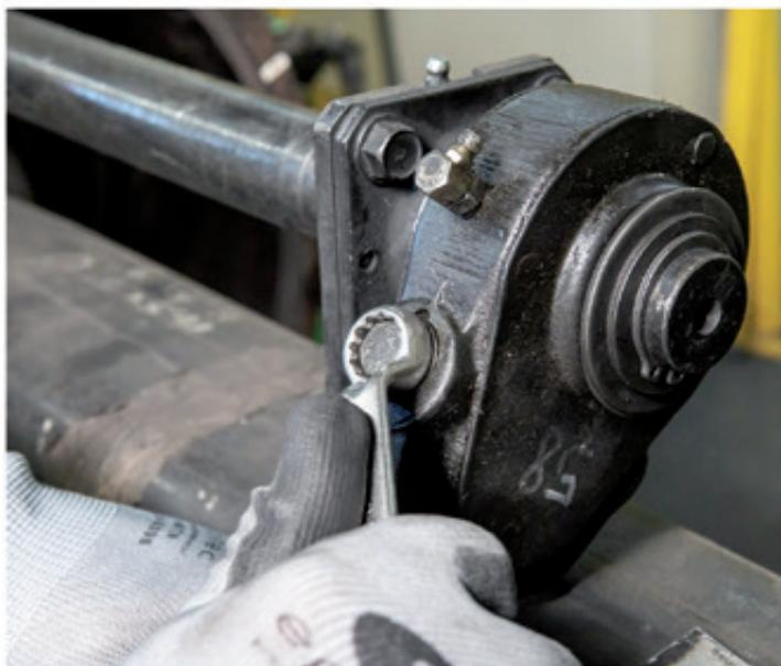
Para desregular o freio deve-se girar o sextavado do sem-fim do ajustador de freio no sentido anti-horário até que o eixo S esteja totalmente recuado. Durante esta operação, alguns modelos de ajustadores automáticos emitem um ruído característico, o que é perfeitamente normal, devido à sua construção. Já outros modelos exigem o destravamento de uma “lingueta”.
