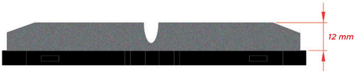
Veja na ilustração abaixo uma pastilha de freio com material de atrito já no FINAL de sua vida útil. A espessura mínima do bolo de atrito está no limite (entre 2 a 3 mm) e deve ser substituída imediatamente:
